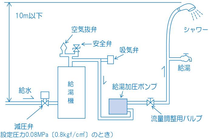
(注) 上記配管例に記載の部品（安全弁、吸気弁など）はすべて別売となります。
