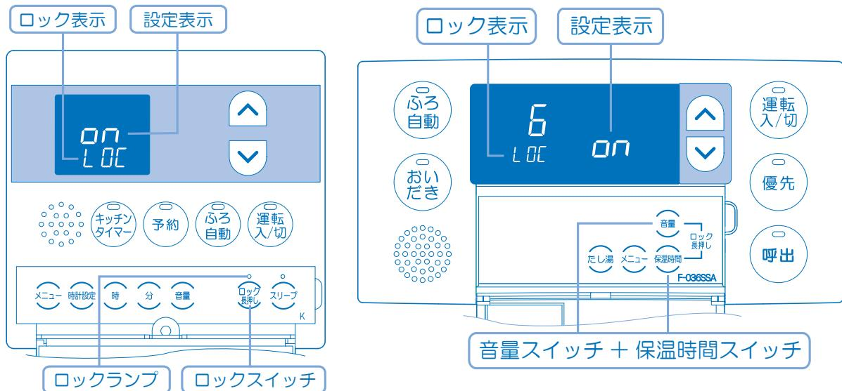
チャイルドロック中に運転スイッチ、呼び出しスイッチ以外のスイッチを押すと、「ピピッ」と音が鳴り、リモコンに「
