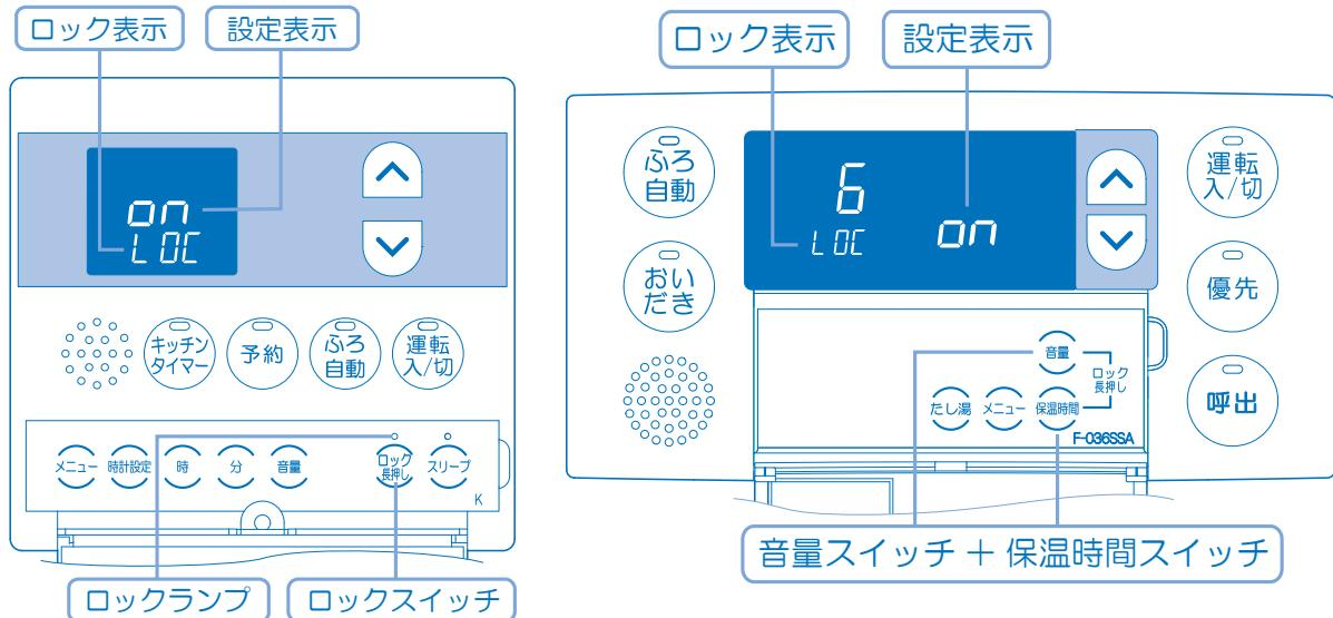
チャイルドロック中に運転スイッチ、呼び出しスイッチ以外のスイッチを押すと、「ピピッ」と音が鳴り、リモコンに「
