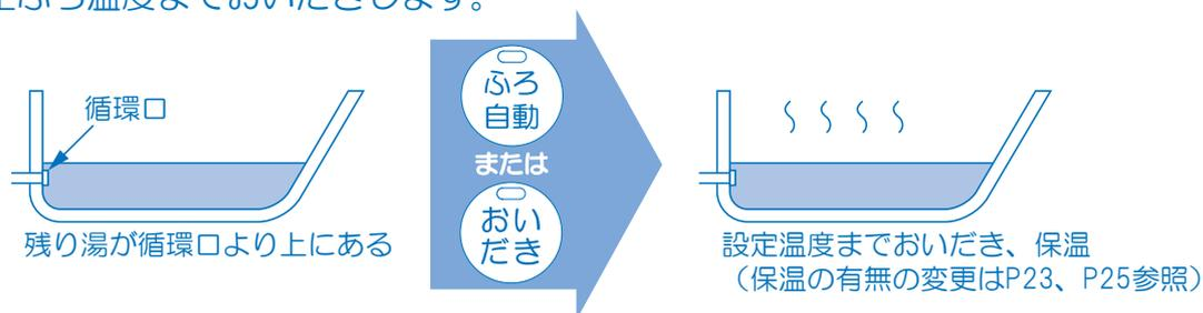
ふろリモコンのたし湯スイッチを押すと、設定された量をお湯はりした後、設定ふろ温度までおいだきして保温します。
