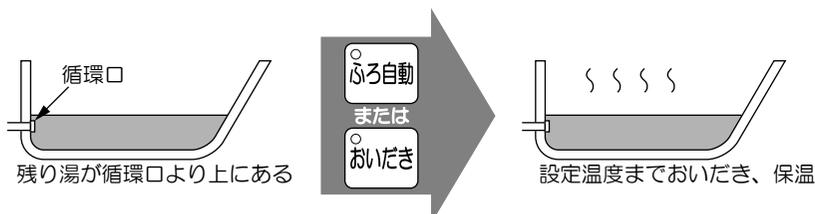
ふろリモコンのたし湯スイッチを押すと、設定された湯量分お湯はりをした後、設定ふろ温度までおいだきして保温します。
