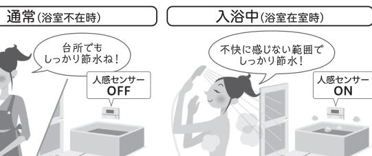
ECOモードをオンになると、浴室の在室／不在状態により、台所用の節水量と浴室用の節水量を自動で切替えます。台所・浴室どちらでも不快に感じない範囲で節水を実践できます。
