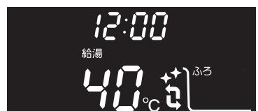
● 配管洗浄中は、
