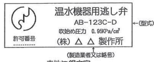
温水器用逃し弁は、吹始め圧力 $0.95\text{kPa}/\text{cm}^2$ とJISマークの表示がある。
